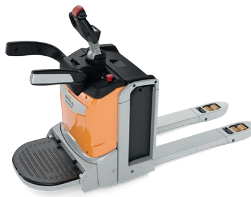
La pedana con sospensione meccanica offre un sostegno ergonomico, aumentando al tempo stesso la capacità di movimentazione
